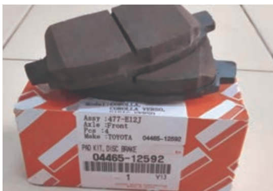
شکل ۶- نمونه‌ای از روش درج شماره فنی
