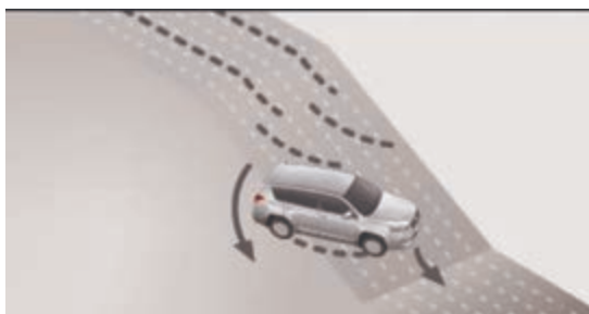
شکل ۲۸- خودروی فاقد سیستم DAC، در سراسیبه‌های تند در زمان ترمزگیری چرخ‌ها را قفل می‌کند.
