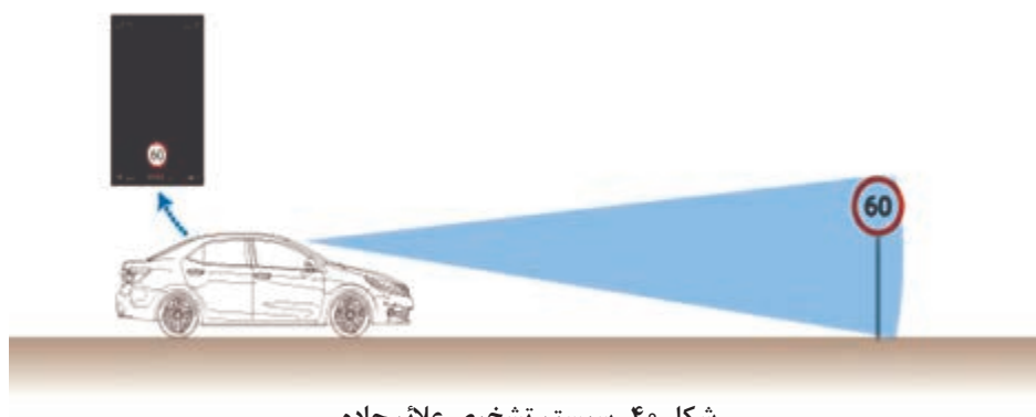
شکل ۴۰- سیستم تشخیص علائم جاده
