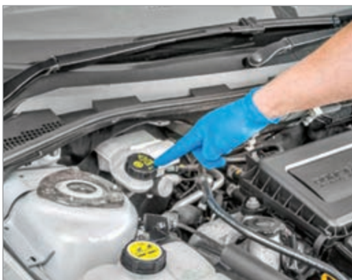
شکل ۱۶-۱- مخزن مایع مشترک در یک خودرو
