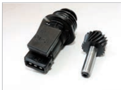
شکل ۲۲-۲- حسگر سرعت خودرو روی جعبه‌دنده
