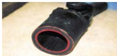
شکل ۳-۱۱- مقطع گاردان دولایه با لایه لاستیک میانی
