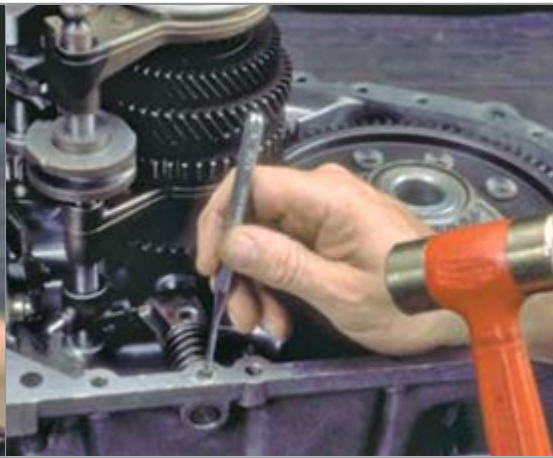
بیرون آوردن پین نگهدارنده اهرم تعویض دنده
