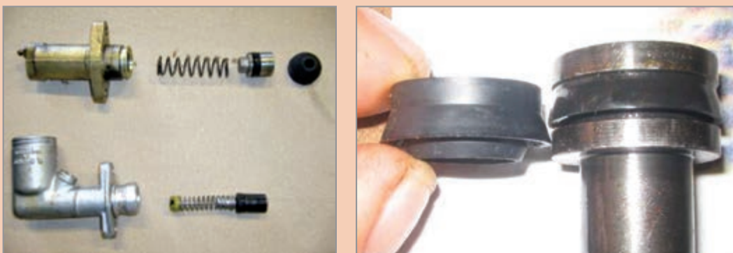
شکل ۲۱-۱- الف - نشتی داخلی در مدار هیدرولیکی
