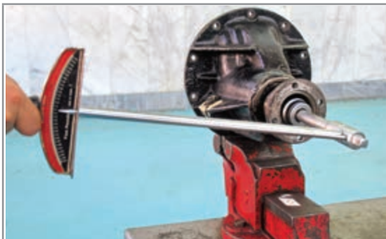
شکل ۴۸-۴- (ب) تعیین گشتاور پیش بار با گشتاورسنج
