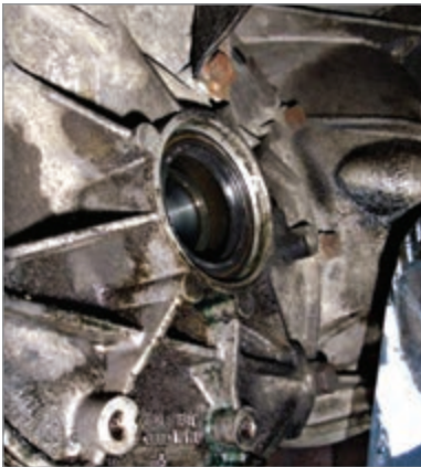
شکل ۲۸-۵- بررسی محل نصب پلوس
