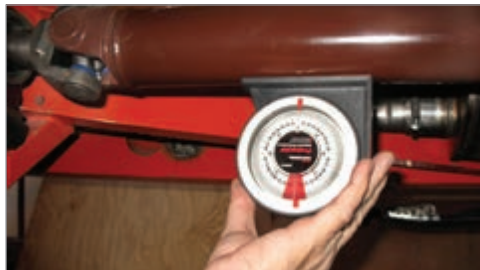
شکل ۱۳-۳- روش استفاده از زاویه سنج میل گاردان
