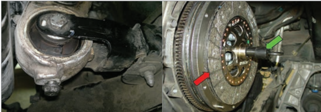
بررسی دسته نگهدارنده جعبه دنده
