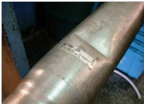
شکل ۱۵-۳- دیدن آثار ضربه روی سطح میل گاردان
