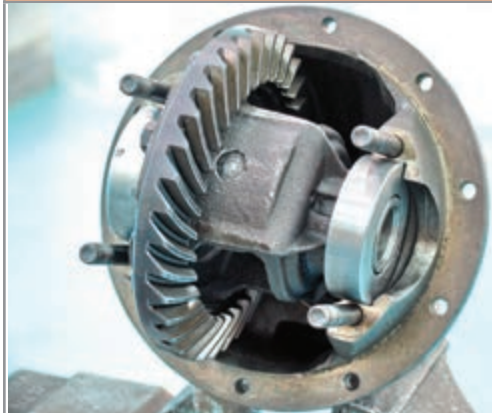
شکل ۴-۵۲- استفاده از رولبرینگ آزمایشی
