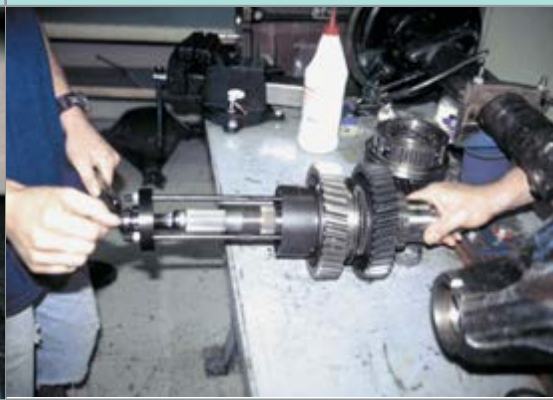
جدا کردن اجزای مجموعه جعبه دنده از روی محورها با کمک پرس و ابزار مخصوص
