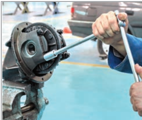
شکل ۵۳-۴- بستن کپه یاتاقان‌ها
