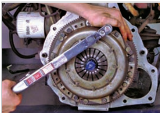
شکل ۱-۳۹- روش به گشتاور رساندن پیچ‌های دیسک کلاچ
