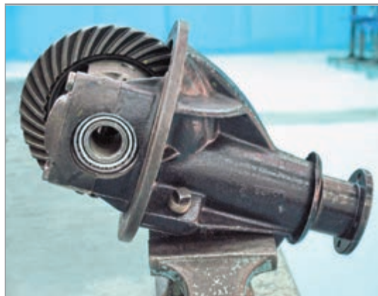
شکل ۲۷-۴- بستن مجموعه دیفرانسیل روی گیره
