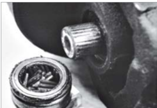
شکل ۲۳-۳- بررسی ساچمه سوزنی
