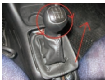
شکل ۲-۲۵- بیرون آوردن سری و گردگیر دسته دنده
