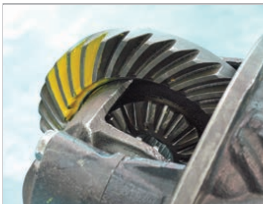
شکل ۴-۲۸- استفاده از رنگ برای آزمایش
