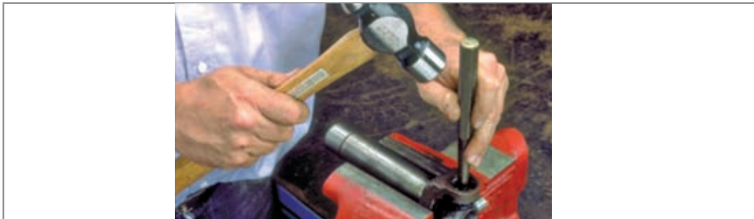
شکل ۲۱-۳- مراحل باز کردن اجزای گاردان
