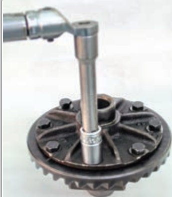
شکل ۵۰-۴- بستن پیچ‌های کرانویل
