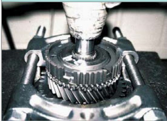
جدا کردن اجزای مجموعه جعبه دنده از روی محورها با کمک پرس و ابزار مخصوص
