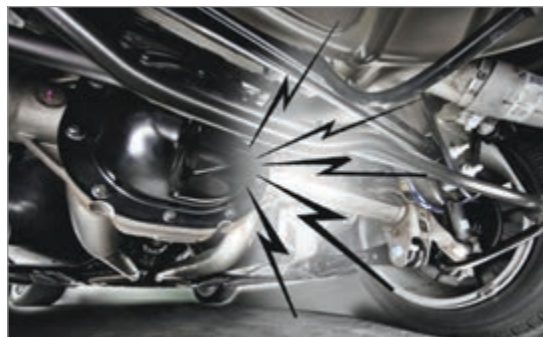
شکل ۸-۴- علل صدای غیر عادی دیفرانسیل
