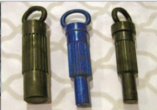
شکل ۱-۳۶- نمونه‌هایی از ابزار هم‌محورکننده صفحه کلاچ
