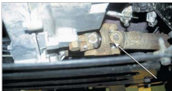
شکل ۶-۳- گاردان با چهارشاخه دویل
