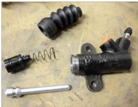
شکل ۱-۲۴- اجزای سیلندر اصلی کلاچ
