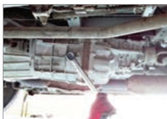
شکل ۲-۲۳- پر کردن روغن جعبه‌دنده
