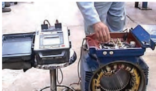
آزمایش تست بدنه موتور با دستگاه میگر
