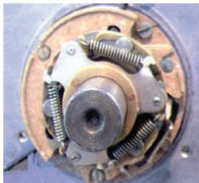
شکل ۸- کلید گریز از مرکز
