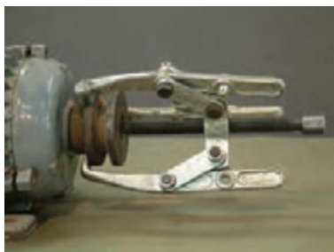
شکل ۱۷- در آوردن پولی از محور موتور
