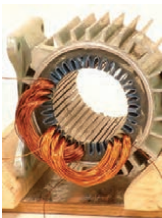
شکل ۶۷- قرار گرفتن دومین گروه کلاف در شیارها
