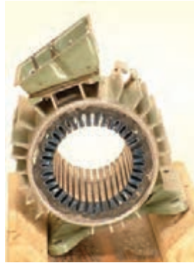
۲۹-۲- استاتور عایق کاری شده
