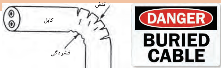
شکل ۲۳- تنش فشردگی خمش کابل
