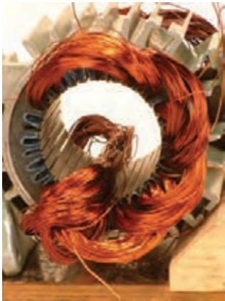
شکل ۶۹- درآوردن بازوهای ۱،۲،۳ برای قرار دادن کلاف آخر
