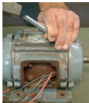
شکل ۱۸- باز کردن پیچ‌های موتور و درپوش‌ها
