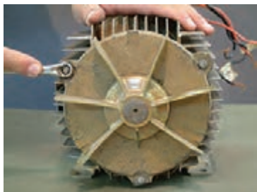
شکل ۱۸- باز کردن پیچ‌های موتور و درپوش‌ها
