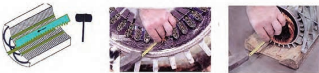
شکل ۲۳- خارج کردن پرسپان از شیار
