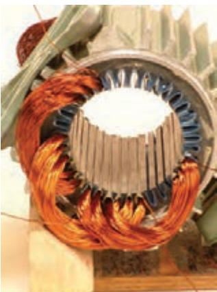
شکل ۶۸- قرار گرفتن سومین گروه کلاف در شیارها
