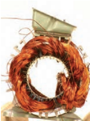
شکل ۷۰- قرار گرفتن آخرین گروه کلاف در شیارهای استاتور
