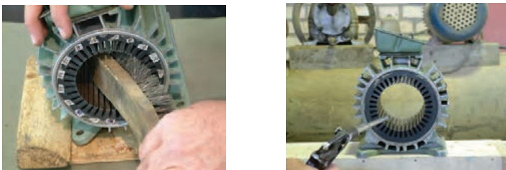
شکل ۲۵-۱ داخل شیارها را با برس تمیز کنید
