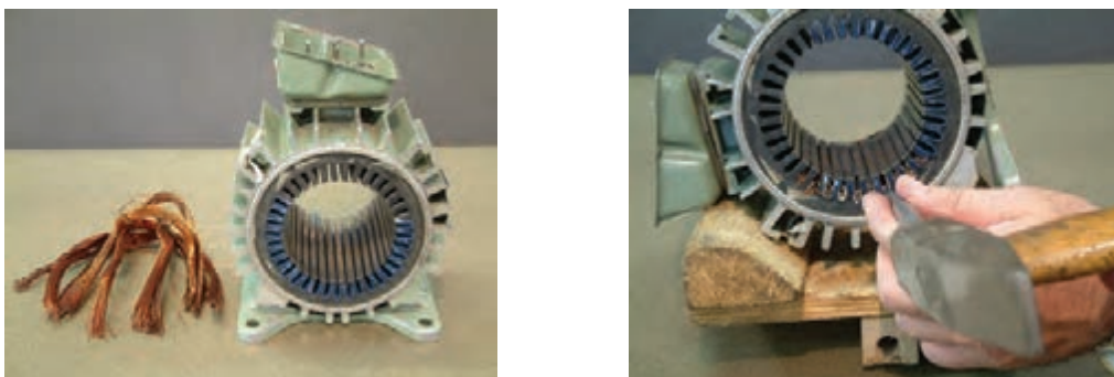
شکل ۲۴- سیم های خارج شده از شیارها
