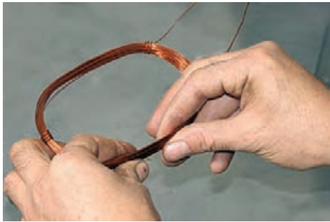
شکل ۳۸-۲ مرتب کردن سیم‌ها جهت کلاف گذاری
