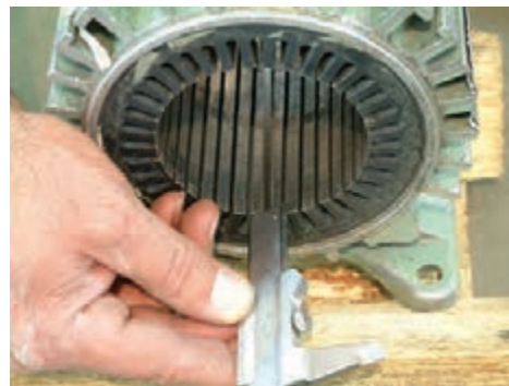
شکل ۲۷- اندازه گیری طول و قطر داخلی استاتور
