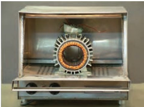
شکل ۲۲- گرم کردن سیم پیچ
