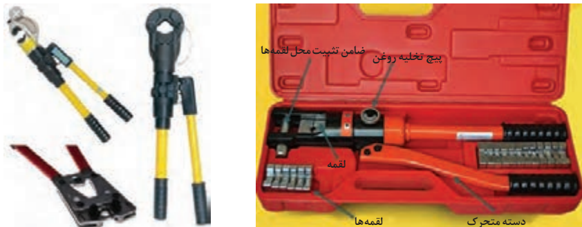
شکل ۱۵- کابلشو هیدرولیکی و دستی
