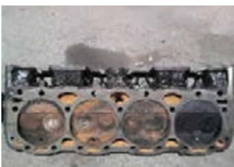
ورود مایع خنک کننده به سرسیلندر
