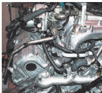
محل نصب EGR روی موتور خودرو
