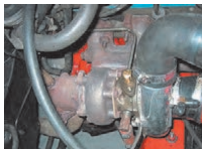
محل نصب توربو شارژر روی موتور
