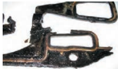
سوختن واشر آب بندی مانیفولد
