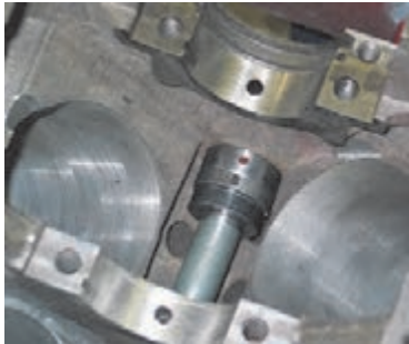
تعویض بوش‌های میل سوپاپ شکل ۱۶۱-۲
