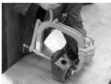
استفاده از فنر سوپاپ جمع کن دستی
