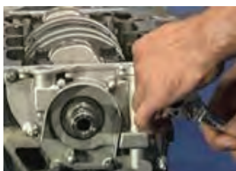
نصب مجموعه روغن بر روی بلوک سیلندر
