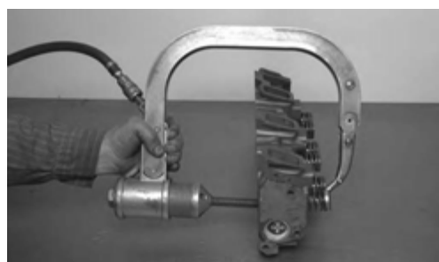
استفاده از فنر سوپاپ جمع کن پنوماتیکی
