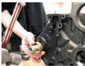
ابزار مخصوص و روش نصب پولکی
