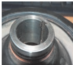
ساییده شدن محل قرارگیری کاسه نم
