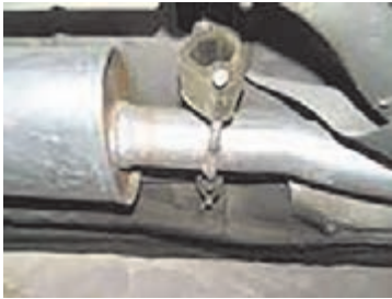
بررسی بست‌های نگهدارنده سیستم اگزوز
