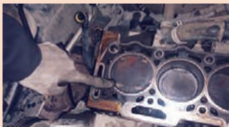
بر خورد سوپاپ‌ها به سر پیستون
