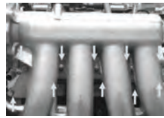
باز کردن پیچ‌های مانیفولد ورودی
