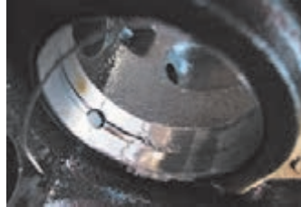
خرابی یاتاقان میل سوپاپ
