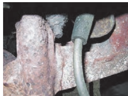
تصویر شکستگی مانیفولد
