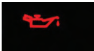
شکل ۹-۴ حسگر فشار و چراغ اخطار فشار روغن
