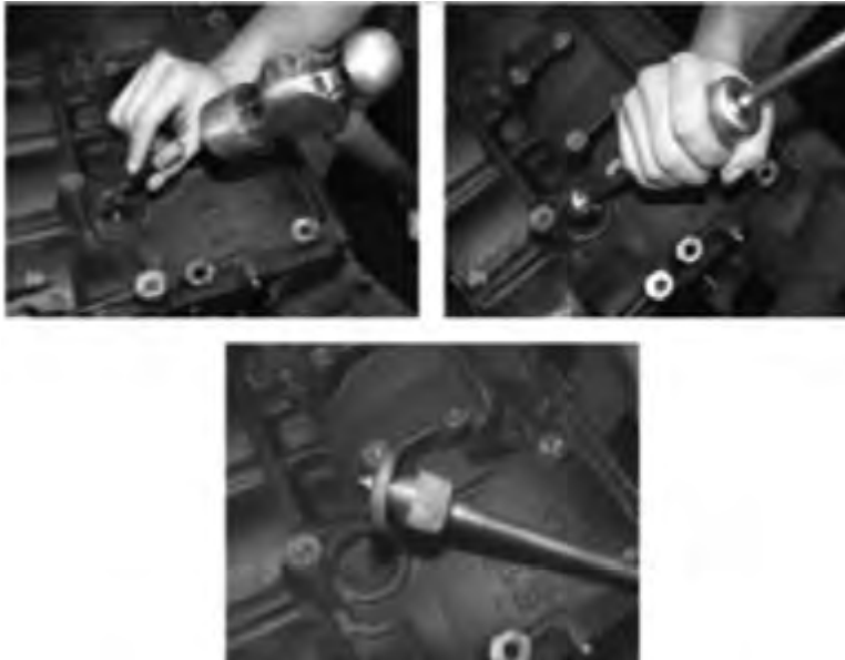
ب) مراحل تعویض پولکی اطراف بلوکه سیلندر شکل ۲-۱۰
