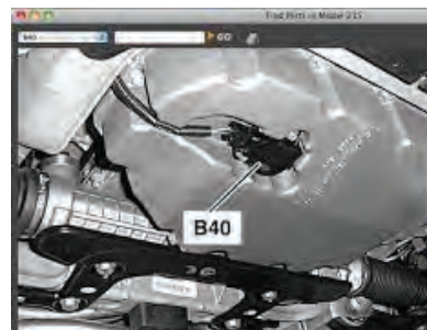
شکل ۱۰-۴ حسگرهای سطح و دمای روغن موتور
