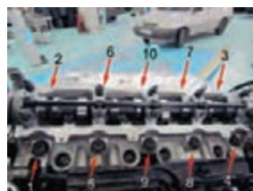
ترتیب باز کردن پیچ های سرسیلندر
