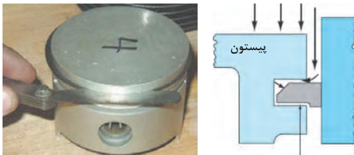
ب) کنترل خلاصی رینگ و پیستون نو
