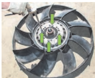
بالانس نبودن پروانه به دلیل خرابی مکان اتصال
