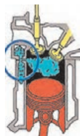
نشستی از محل های مختلف بوش سیلندر و واشر سرسیلندر و بالای بوش
