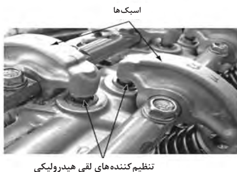
سرسیلندر دارای اسبک‌های تنظیم کننده هیدرولیکی
