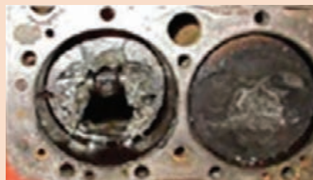
ذوب شدن پیستون
