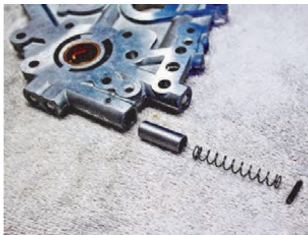
شکل ۶-۴ محل قرارگیری سوپاپ کنترل فشار
