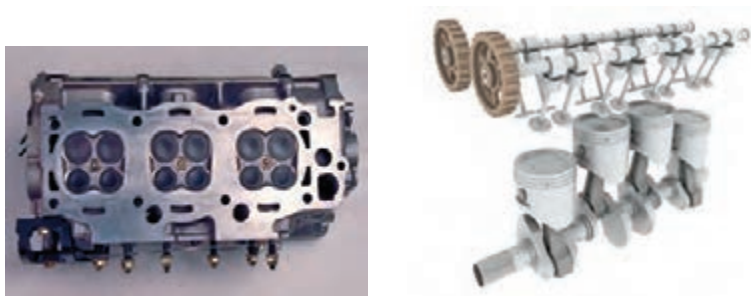
سرسیلندر آلیاژ آلومینیومی با دو میل سوپاپ رو (هر سیلندر بیش از ۲ سوپاپ)
