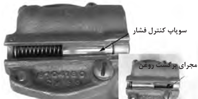
بررسی سلامت اجزای سوپاپ کنترل فشار
