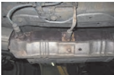
محل نصب حسگر اکسیژن روی مبدل کاتالیست
