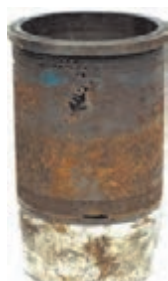
نشستی از محل های مختلف بوش سیلندر و واشر سرسیلندر و بالای بوش
