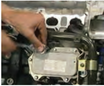
نصب خنک کن روغن بر روی موتور
