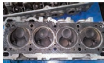
سوختن واشر سرسیلندر و نشستی کمپرس در سیلندر ۱
