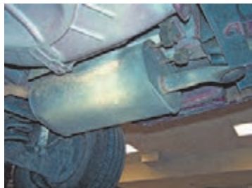
محل قرارگیری لاستیک نگهدارنده اگزوز روی خودرو
