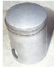
الف) پیستون قدیمی با وزن بیشتر
