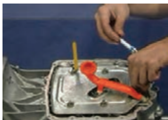
باز کردن صافی روغن ورودی به پمپ
