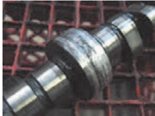
خرابی تکیه‌گاه میل سوپاپ شکل ۱۶-۲
