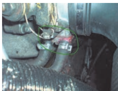
شکل ۱۰-۲ الف) نشستی از لوله‌ها و پولک اطراف سیلندر
