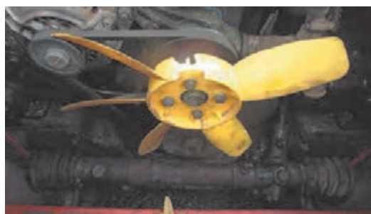
وجود شکستگی یا ترک پره‌ها
