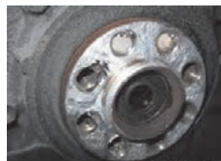
الف) خرابی جای پیچ فلاپیول بر روی میل لنگ
