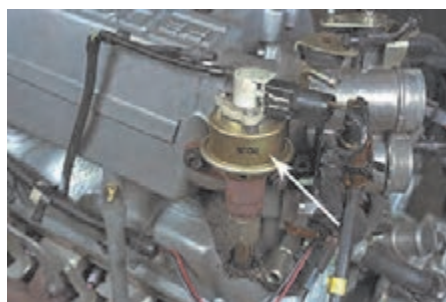
محل نصب EGR روی موتور خودرو
