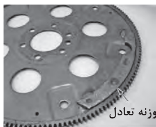
الف) اتصال وزنه بر روی پولی جهت بالانس شکل ۸۵-۲ (ب) چسباندن وزنه بر روی صفحه ارتعاشی جهت بالانس (فلاپویل)
