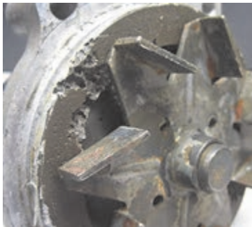
خرابی بلبرینگ و خوردگی داخلی
