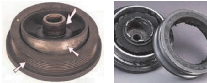
پاره شدن لاستیک میان دو حلقه
