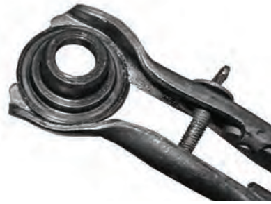
تنظیم گیره نگهدارنده بشقابک سوپاپ در فنر سوپاپ جمع کن
