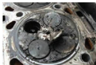
ذوب شدن سوپاپ
