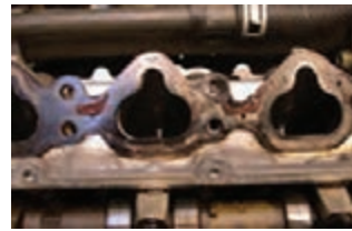
آثار نشتی مانیفولد دود روی سرسیلندر
