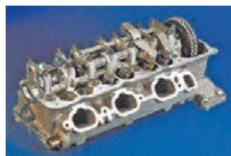
محل نصب مانیفولد خروجی روی
