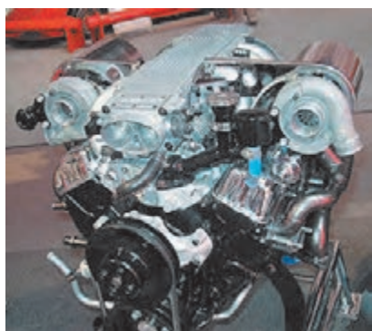
شکل ۳-۴ موتور V شکل
