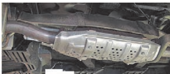
شکل ۲۷-۳ محل نصب سپر حرارتی در سیستم اگزوز
