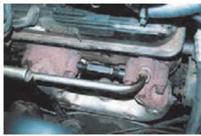
تصویر نشستی دود بین مانیفولد و سرسیلندر
