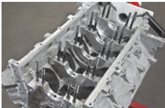
شکل ۲-۲۹ پیچ‌های اتصال کپه یاتاقان‌ها و محفظه لنگ
