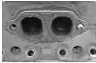
بریدن پیچ اتصال مانیفولد دود داخل سرسیلندر
