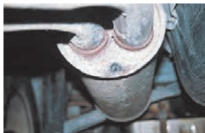
تصویر سوراخ شدن کاتالیست
