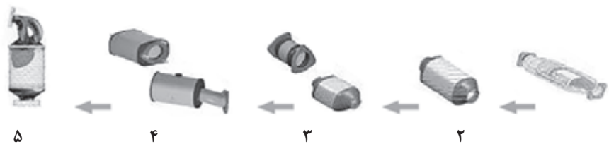
شکل ۱۲-۳ سیر تکاملی مبدل های کاتالیستی
