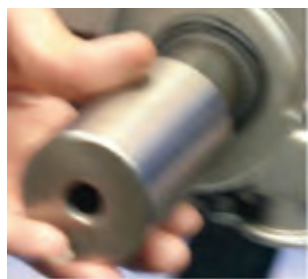
نصب کاسه نمدها با ابزار مخصوص
