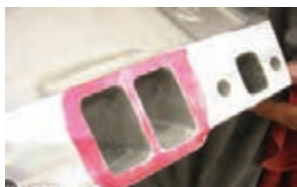
تابیدگی در مانیفولد ورودی
