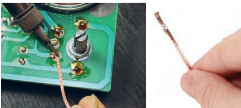
شکل ۸۰-۱- برداشتن قلع از روی فیبر
