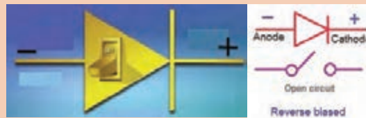
شکل ب ۳-۸- دیود ایده‌آل در بایاس مخالف
