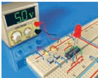
شکل ۷-۴- بستن مدار روی بردبرد و آزمایش آن
