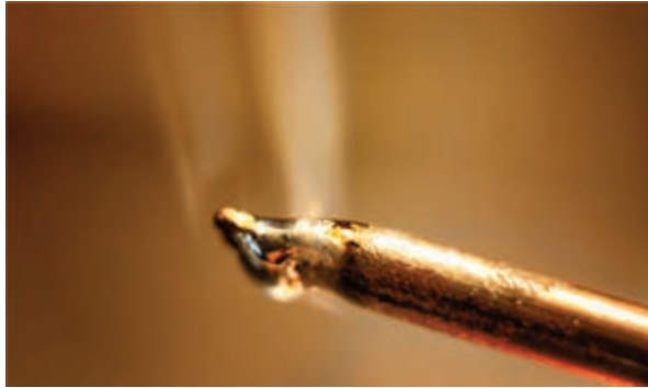
شکل ۴۱-۱- فرو بردن نوک هویه در روغن لحیم
