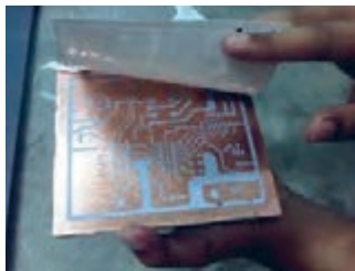
شکل ۱۱-۷- جدا کردن کاغذ از سطح روی فیبر
