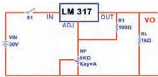
شکل ۸۲-۳- مدار آزمایش با آی سی رگولاتور متغیر
