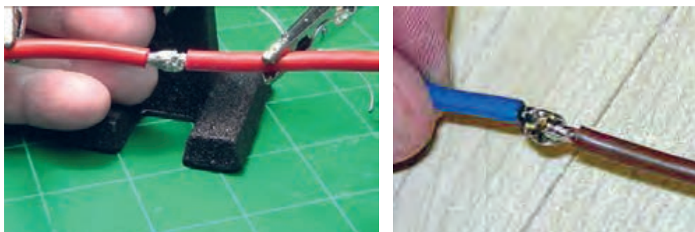
شکل ۱-۵۳ - اتصال دو رشته سیم افشان
