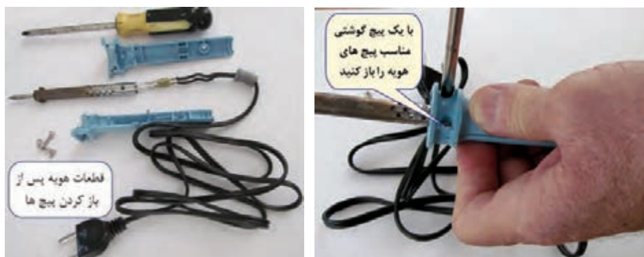
شکل ۹۴-۱ - چگونگی باز کردن هویه قلمی و اجزاء آن
