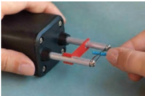
شکل ۱-۲۳ - سیم لخت‌کن ساده و حرارتی
