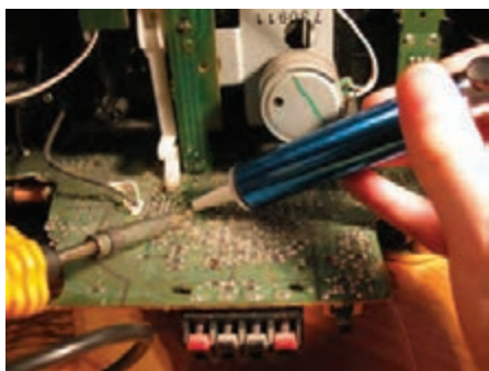
شکل ۸۴-۱- مراحل ذوب شدن و مکش قلع
