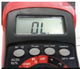
شکل ۳-۶- وضعیت تست دیود در بایاس موافق
