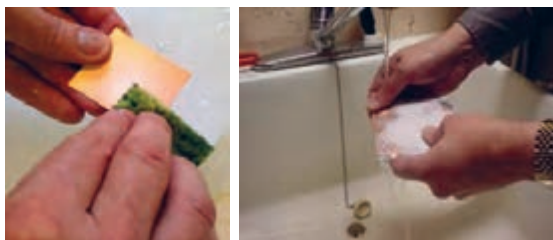
شکل ۵-۱۹- شستشو و تمیز کردن فیبر مدار چاپی
