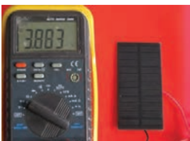
شکل ۳-۹۵- اندازه‌گیری ولتاژ سلول خورشیدی
