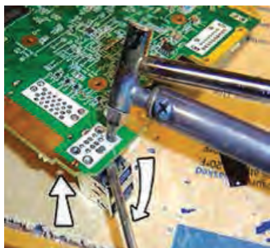
شکل ۸۷-۱- استفاده از قلع کش حرارتی
