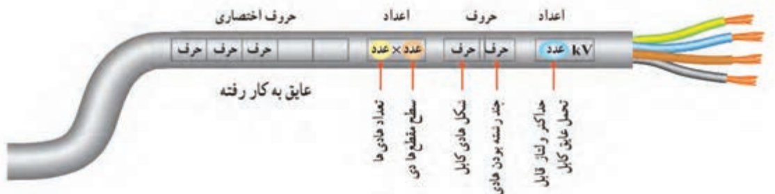
شکل ۲-۱ - مشخصات فنی یک نوع کابل
