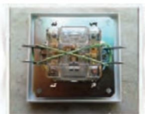
شکل ۲-۸۰ - ساختمان داخلی کلید کولر
