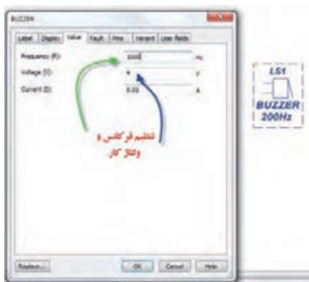
شکل ۶-۲۵- تنظیم فرکانس و ولتاژ کار بی‌زر
