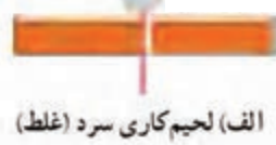
شکل ۵۰-۱- لحیم‌کاری صحیح و غلط
