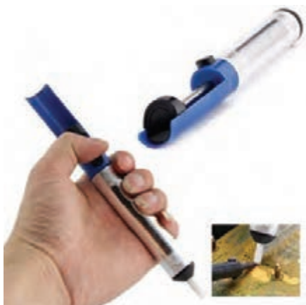
شکل ۸۳-۱- شارژ قلع کش پیستونی و قرار دادن آن روی پایه
