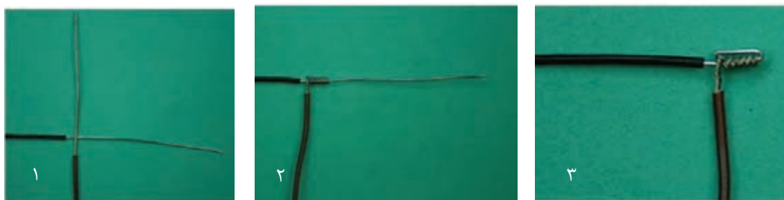
شکل ۱-۵۲- اتصال سیم افشان به سیم مفتولی
