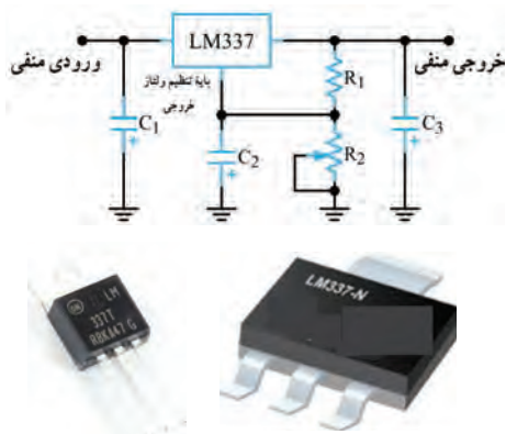
شکل ۳-۸۱- نقشه مدار و تصویر دو نمونه رگولاتور منفی
