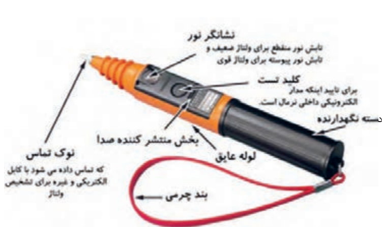
شکل ۳۸-۲- ساختمان داخلی فازمتر دیجیتالی
