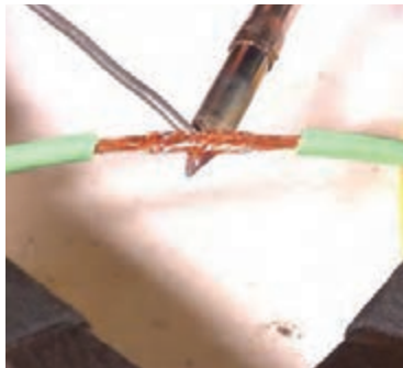
شکل ۴۹-۱- لحیم یک اتصال با سیم افشان
