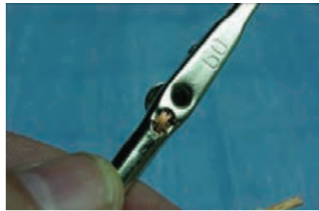
شکل ۶۸-۱ - عبور سیم از گیره سوسماری
