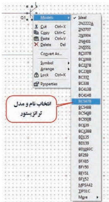
شکل ۱۹-۶- نحوه انتخاب نام و مدل ترانزیستور
