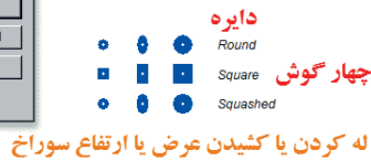
شکل ۶-۳۵- تعیین ویژگی‌های Padها
