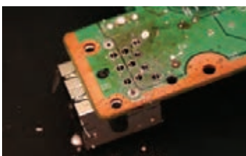
ب- برداشتن لحیمها و آزاد کردن پایهها
