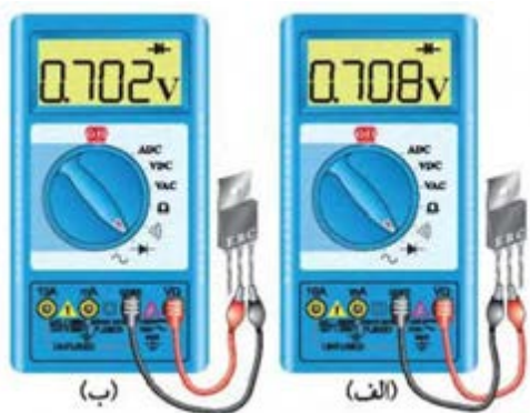
شکل ۴-۴- ولتاژ موافق کلکتور-بیس و امیتر-بیس
