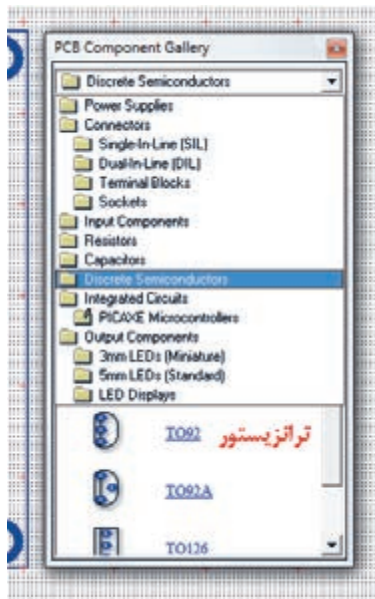
شکل ۴۹-۶- انتخاب پایه‌های ترانزیستور BC547
