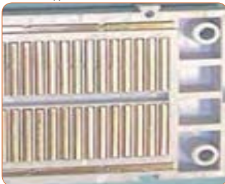
شکل ۸۹- ۱- اتصالات داخلی برد بُرد
