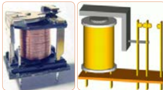
شکل ۳۴-۶. ساختمان داخلی دو نوع رله
