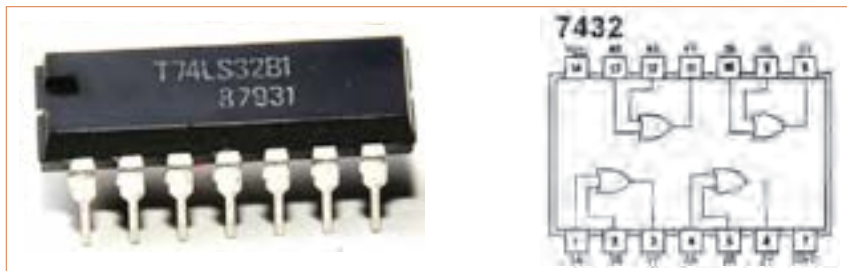
شکل ۵۳-۶- نمای ظاهری و اتصال پایه‌ای آی سی ۷۴۳۲
