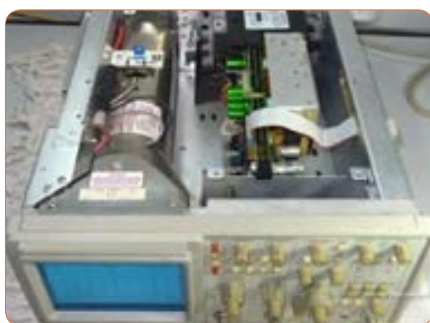
شکل ۵۲-۴- ساختمان داخلی یک نوع اسیلوسکوپ
