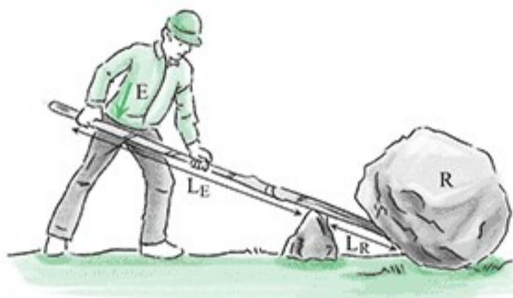
به شکل مقابل توجه کنید. در این شکل می‌خواهیم با نیروی محرک  $E$  نیروی مقاوم  $R$  را جابه‌جا کنیم. اگر جابه‌جایی نیروی مقاوم را با  $d_R$  و جابه‌جایی نیروی محرک را با  $d_E$  نشان دهیم در صورتی که اتلاف انرژی وجود نداشته باشد، یعنی از اصطکاک چشم‌پوشی کنیم، کار دو نیرو با هم برابر است. کار نیروی محرک ( $W_E$ ) برابر است با:  $W_E = E \cdot d_E$  و مقدار کار نیروی مقاوم ( $W_R$ ) برابر است با:  $W_R = R \cdot d_R$
